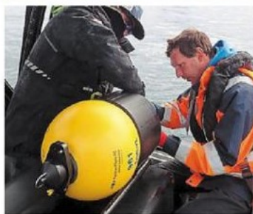
Opération de marquage à bord d'un palangrier, dans la zone du parc éolien au large de Saint-Nazaire : un émetteur sonore est placé sur une raie, un peu comme un piercing et les récepteurs sont plongés en mer.
